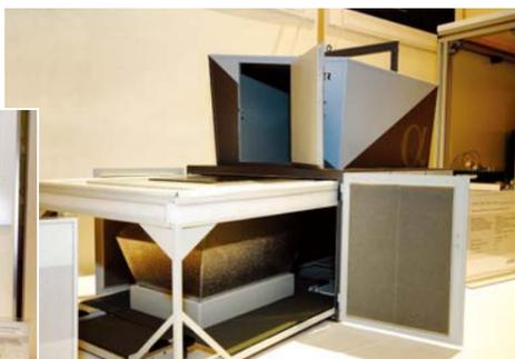
ISOCELL : 防音部品の音響透過損失測定装置(フラットサンプルおよび成形部品を測定可能)
