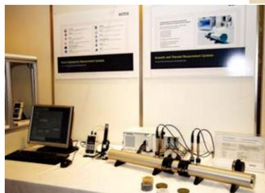
ELWIS-A : 多孔質材料(フェルト、フォーム)の音響パラメータ測定装置
