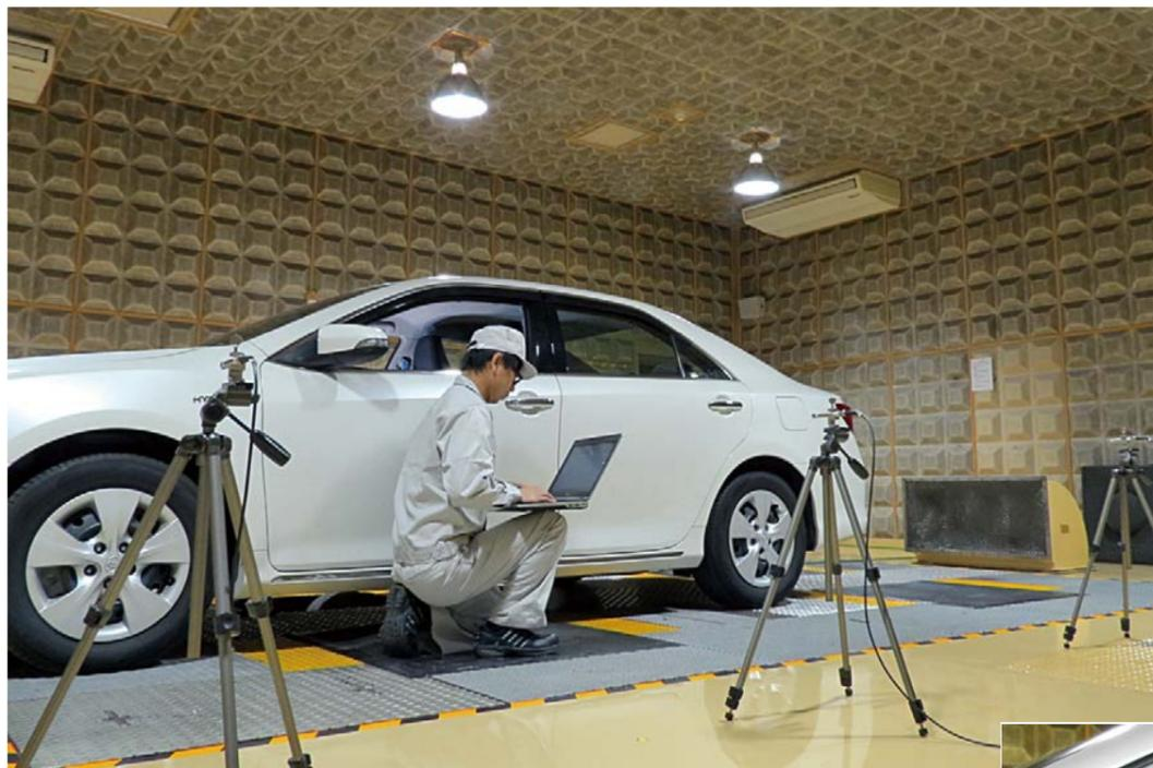
音響解析のための実車テストベンチ(スムーズ&ラフ面) Test bench for acoustic analysis
